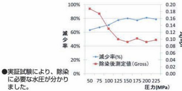
●超高压水によりレンガ同士の隙間を除染します。
